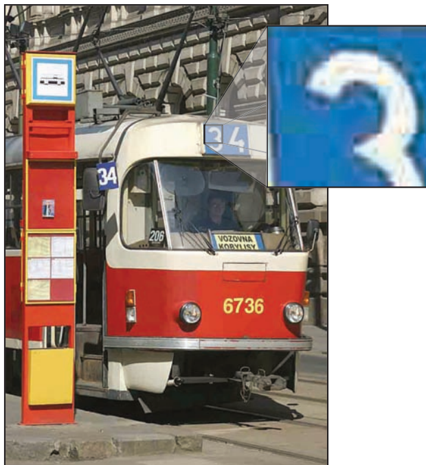
RYSUNEK 2.11. Ten obraz został poddany zbyt silnej kompresji, na co wskazuje obecność artefaktów typowych dla kompresji JPEG
