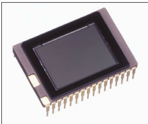
RYСУNEK 2.4. Matryca CCD firmy Kodak pochodząca z aparatu Olympus E1 zawiera światłoczuły obszar o rozmiarach 18 \times 13,5 mm
